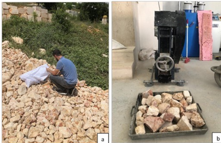
Şekil 3. a) Mermer ocağı mermer atığı temini, b) Mini konkasör yardımı ile malzeme kırımı.
