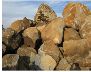
Şekil 4. Ocaktan alınmış işlem görmemiş gözenekli gözeneksiz ve bazalt kayalar (Kahveci, A. ve Kadayıfçı, A., 2013)
