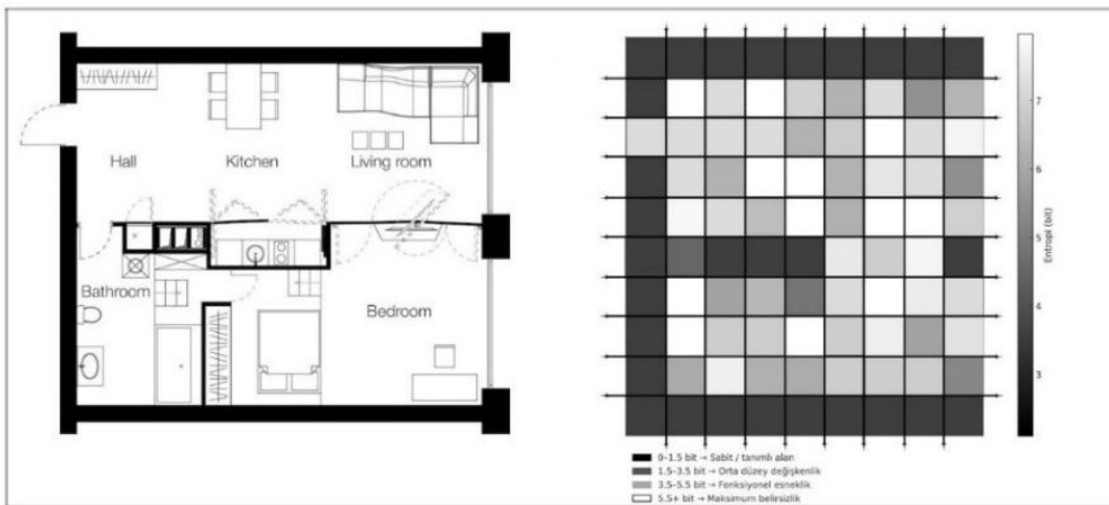
Şekil 4. Transformer Apartmanı Planı ve 10x9 Grid ile Shannon Entropisi Dağılımı ((Plan kaynağı: Archipanic.com, Grid ve Entropi Görselleştirmesi: Yazar tarafından hazırlanmıştır.).
