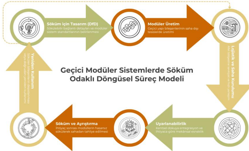
Şekil 1. Modüler sistemlerde sökülüm odaklı döngüsel süreç modeli (yazarlar tarafından geliştirilmiştir).
