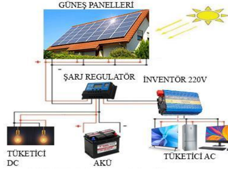
Şekil 1. Şebekeden bağımsız sistem şeması [URL-2]'den uyarlanmış, yazar tarafından güncellenmiştir.
